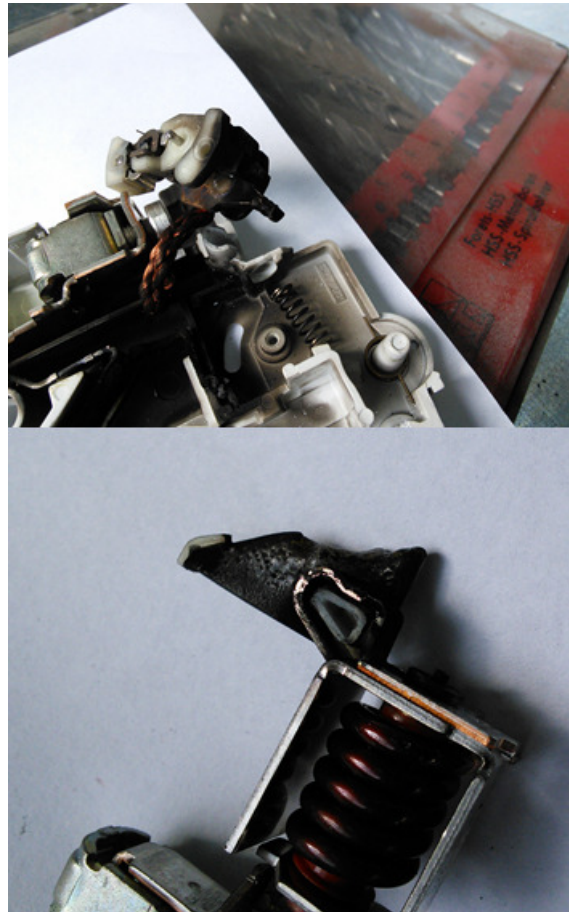
Rys. 12. Upalenie styków. Wyłącznik C40 producenta A
