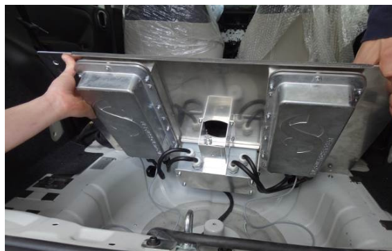
Rys. 7. Ładowarki baterii trakcyjnej zamontowano w przestrzeni koła zapasowego. Zastosowano dwie ładowarki o łącznej mocy 6 kW
