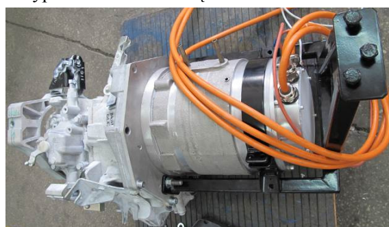
Rys. 2. Silnik IPMSM napędu E-Kit zmontowany z fabryczną skrzynią biegów samochodu osobowego
