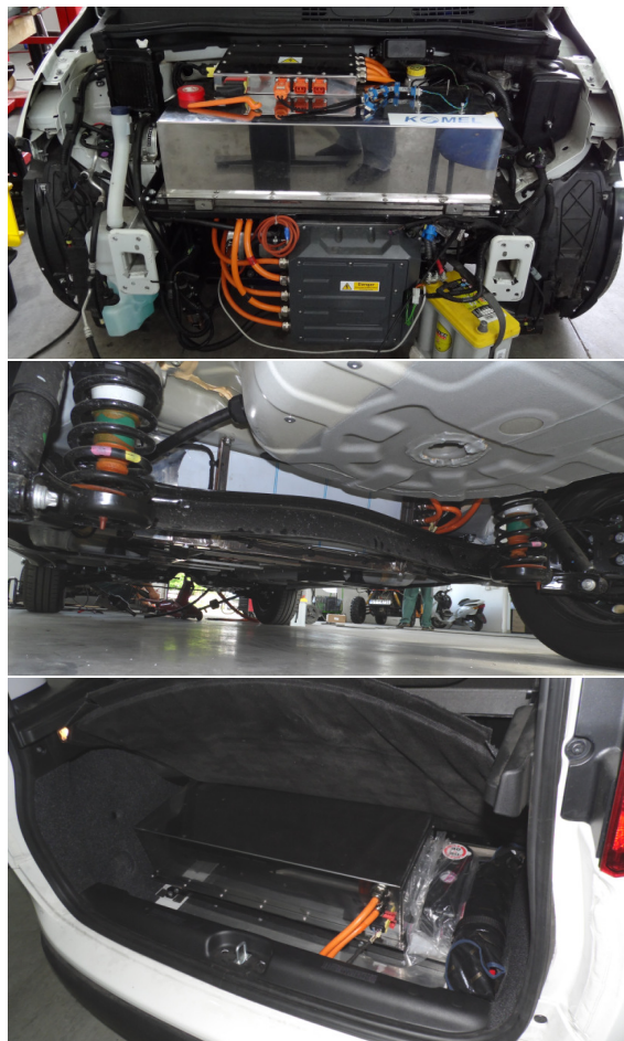
Rys. 6. Rozmieszczenie modułów 5 kWh baterii trakcyjnej w samochodzie osobowym z napędem E-Kit, od góry: w komorze silnika, zamiast zbiornika paliwa, w bagażniku
