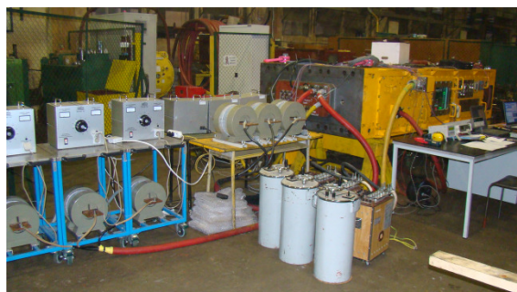
Rys. 3. Stanowisko badania nagrzewania
