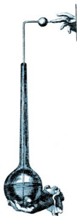
Rys. 1. Flaszka Kleista była elementem magazynującym energię elektryczną (kondensatorem), w którym zewnętrzną okładziną była ludzka dłoń, a wewnętrzną zwykła woda wypełniająca naczynie [4]
