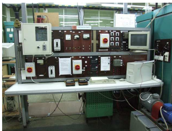
Rys. 2. Zdjęcie stanowiska laboratoryjnego do badania generatora indukcyjnego wzbudzanego kondensatorami
